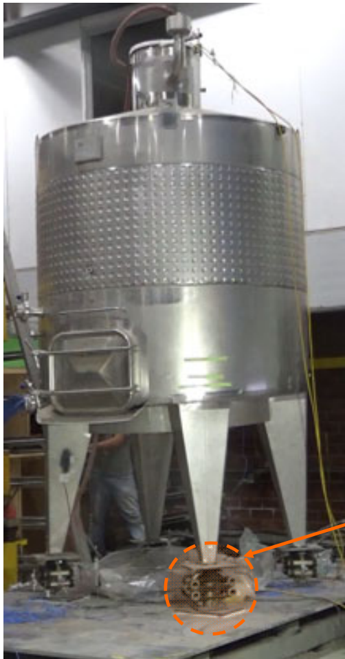
Montaje experimental en mesa vibradora 1D
